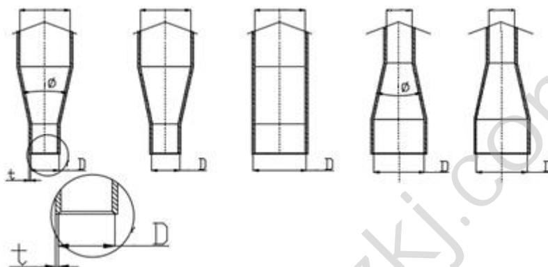
注：采样嘴要求： $t \leq 0.2\text{mm}$ ， $\phi \leq 45^\circ$
