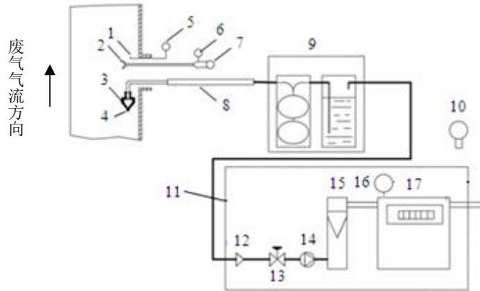
1-温度探头；2-皮托管；3-采样头；4-采样嘴；5-温度测量；6-静压测量；7-压差测量；
